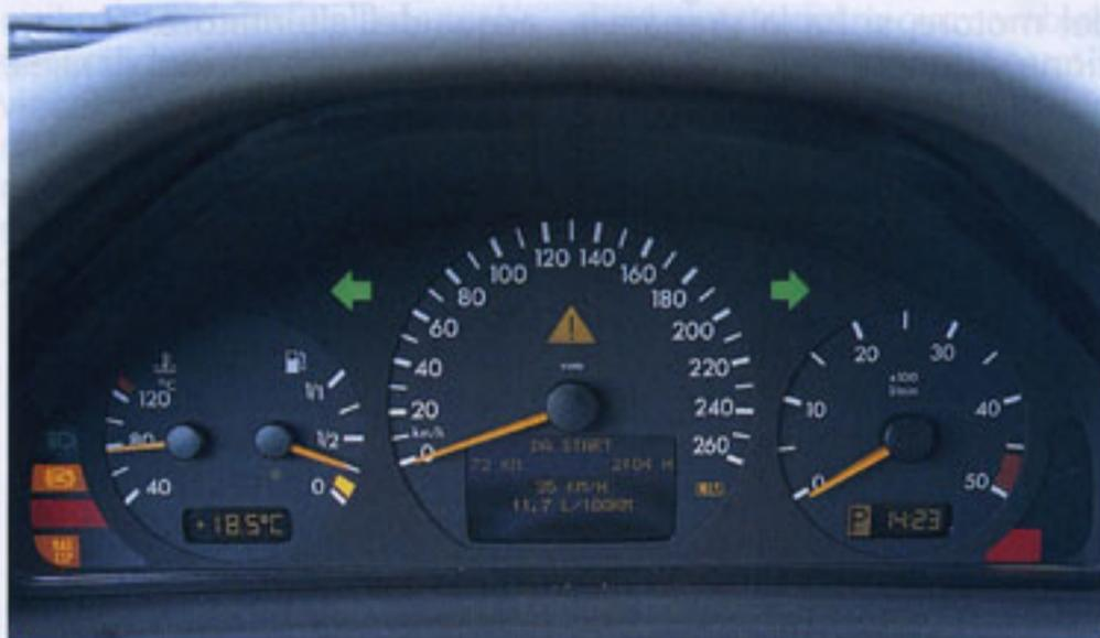
**DIGITALE** - Al centro del cruscotto si trova il nuovo pannello digitale: vi sono indicate le principali funzioni che possono essere regolate tramite i pulsanti disposti sul volante. L'impianto hi-fi e il climatizzatore sono di serie
